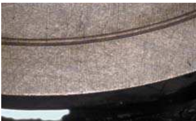
Einlaufrille nach 24 Stunden Run-in groove after 24 hours
