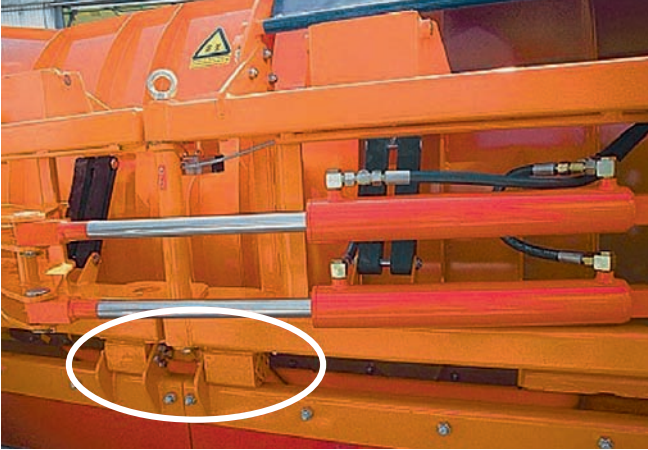
Abstreiferfederung an einem Schneeflug Wiper suspension of a snow plow
