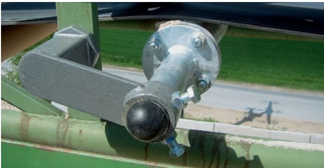
Bandabstreifer mit RESATEC Spanner und Spezialringhebel Belt scraper with RESATEC tensioner and special ring lever
