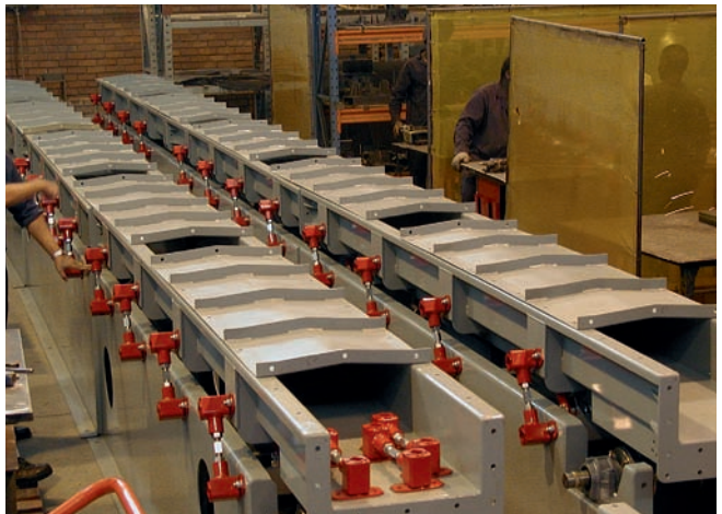
Einfache Schwingförderrinne mit OM-Elementen Single deck vibrating feeder with OM elements
