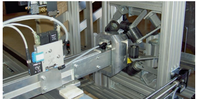
Universalspanner mit Rolle an einer Verpackungsmaschine Universal tensioner with a rollerset on a packaging machine
