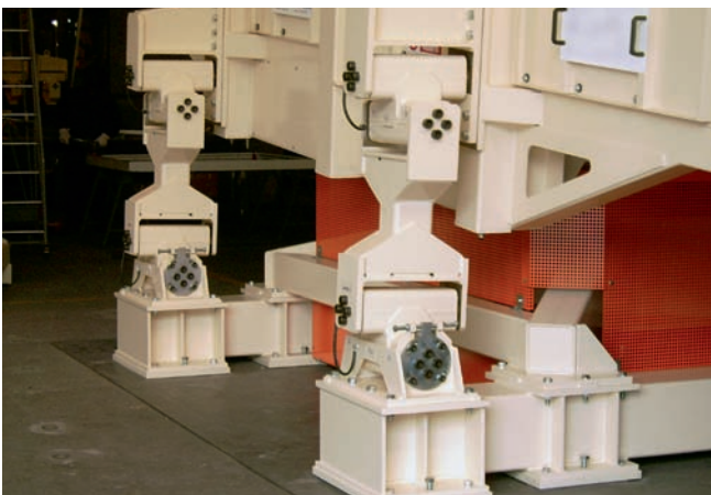
Universalschwingelement an einem Sichter Universal oscillating unit on a gyratory sifter
