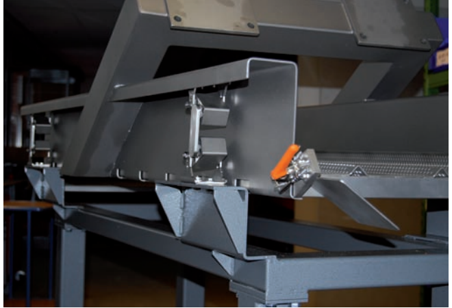
Schwingelement an Entwässerungsrinne Oscillating unit on dewatering screen
